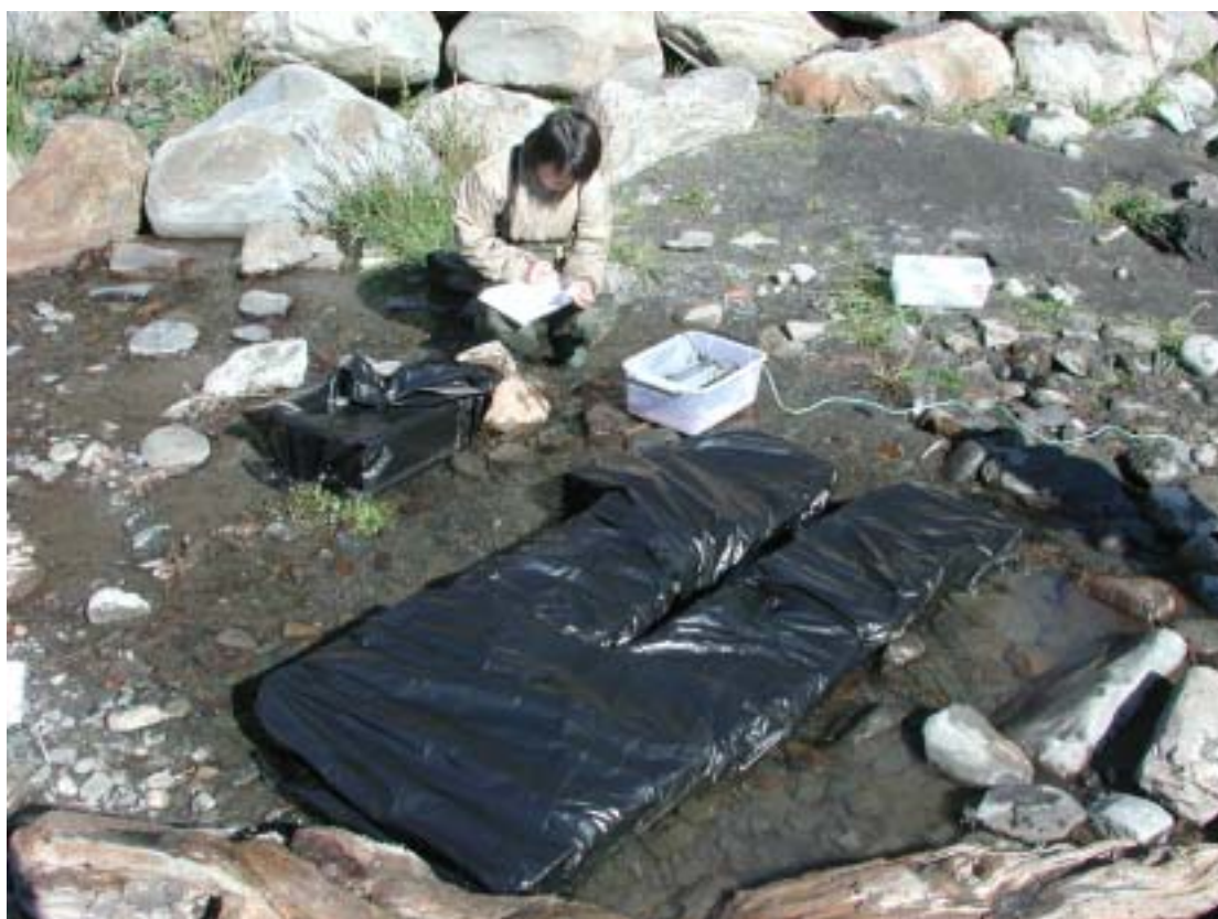
將培養箱以黑布遮光，測量呼吸作用溶氧變化情形
